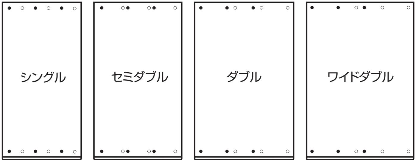
横開きの収納場合、リンク金具取付位置のビス穴を間違わないよう注意してください。
